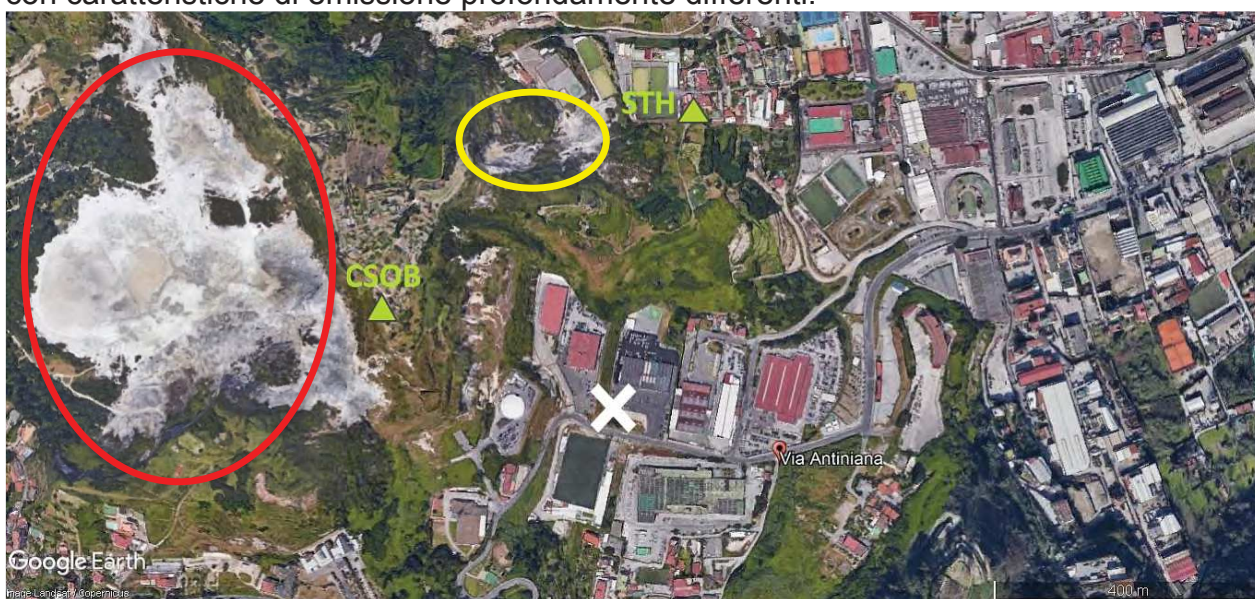
Fig.3: mappa con la collocazione: dell'area interessata dalla perforazione (individuata dalla posizione della x bianca), delle stazioni sismiche CSOB e STH interessate dal disturbo indotto dalla perforazione, della Solfatara (ellissi rossa) e Pisciarelli (ellissi gialla)
