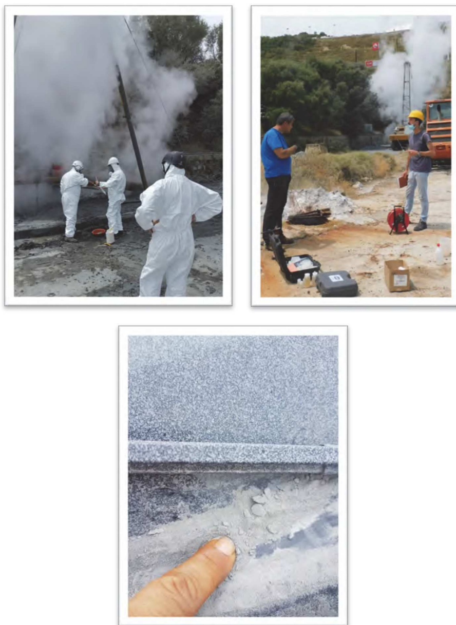
Fig. 5: Campionamento dei fluidi emessi dalla perforazione (a sinistra); misure effettuate nel pozzo preesistente (al centro), particolato depositatosi sulle auto in sosta nel piazzale (a destra)
